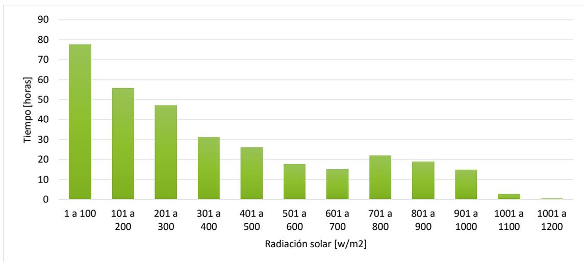
**Figura 5. Datos de radiación agrupados por frecuencia [ $w/m^2$ ]**
